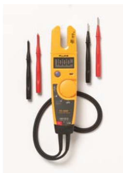
Fluke T5-1000 Elektrisk tester med OpenJaw™-strøm Med den elektriske tester Fluke T5 kan du kontrollere spænding, gennemgang og strøm med ét kompakt værktøj. Du skal blot vælge volt, ohm eller strøm og testeren gør resten af arbejdet. OpenJaw™-strøm giver dig mulighed for at kontrollere strøm på op til 100 A - uden at afbryde kredsløbet.
