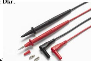
TL76 Et par (rød, sort) 1.5 meter lange silikonetestledninger med retvinklede, isolerede bananstik Lanternespidser (aftagelige) til brug i europæiske stikkontakter (4 mm 0/) Aftagelige, isolerede IC-hætter muliggør undersøgelse af ledninger, der er anbragt tæt sammen og er i overensstemmelse med GS38 KAT II 1000 V, 10 A-klassificering KAT III 1000 V, KAT IV 600V kun med beskyttelseshætte Et års garanti Pris: Dkr.
